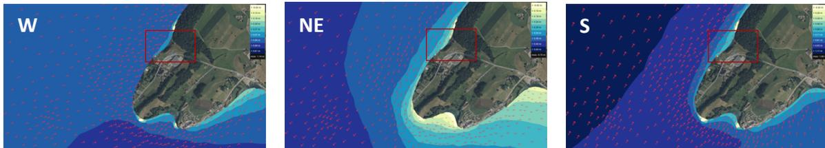
Abb. 2: Modellierung der Wellenhöhe zeigt die geschützte Lage (hier beispielsweise bei einer Wiederkehrperiode von 30 Jahren; links Windrichtung West, Mitte Windrichtung Nordost, rechts Windrichtung Süd). Quelle: Wellenmodell von swisslakes.net
